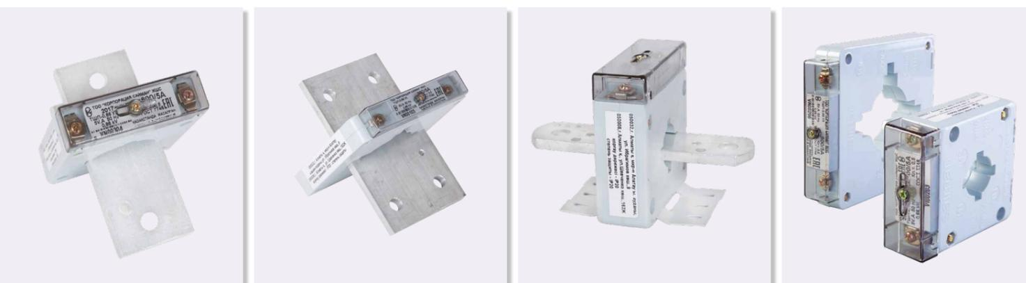
Трансформаторы тока опорный **ТОП-0,66 УЗ** и шинный **ТШП-0,66 УЗ** предназначены для передачи сигнала измерительной информации приборам измерения, защиты, автоматики, сигнализации и управления в электрических цепях переменного тока частотой 50 и 60 Hz номинальным напряжением до 0,66 kV включительно в условиях умеренного климата при рабочей температуре  $-45...+40^{\circ}\text{C}$  и относительной влажности воздуха не более 80% при температуре  $25^{\circ}\text{C}$ .
