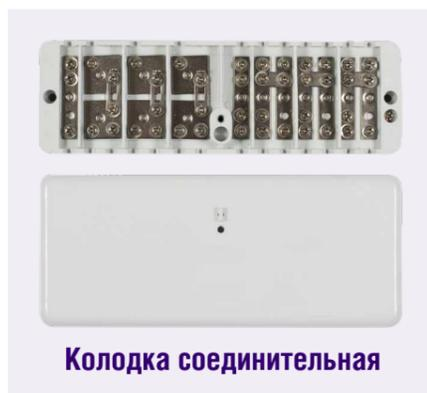
**Колодка соединительная** предназначена для 3-х фазных электросчетчиков и обеспечения смены счетчиков для ремонта или их поверки на месте установки, без отключения нагрузки потребителя в закрытых помещениях.
