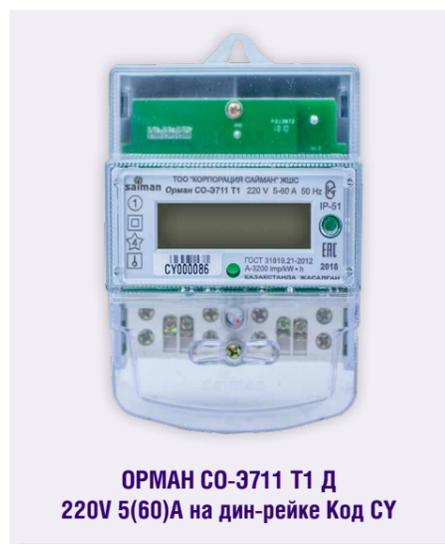
Статический (электронный) счетчик активной энергии **ОРМАН СО-3711 Т1 Д на дин-рейке Код СУ** однофазный предназначен для измерения активной энергии в однофазных двухпроводных цепях переменного тока по одному тарифу. Учёт активной энергии в одно-тарифном режиме, телеметрический выход, крепление на дин-рейку.
