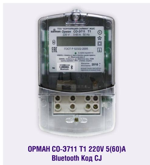
Статический (электронный) счетчик **ОРМАН СО-3711 Т1 Код CJ** активной энергии переменного тока однофазный предназначен для учета активной электрической энергии в однофазных цепях переменного тока по одному тарифу. Счетчик снабжен беспроводной системой связи Bluetooth (BLE 4.0), что дает возможность прочитать данные со смартфона и использовать счетчик в биллинговой системе и в современных решениях проектов «Умный дом».
