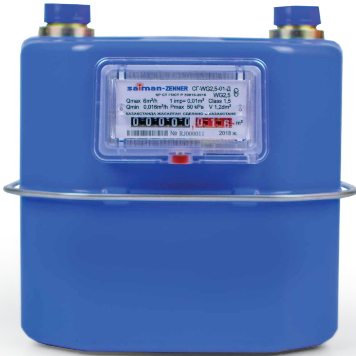
Счетчик газовый СГ-G2,5-01-Д предназначен для измерения расхода газа в квартирах и домах с газовыми колонками и плитами. Межосевое расстояние – 110 мм.
